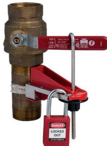
Ogni persona che lavora all'attrezzatura di lavoro disporrà del proprio bloccaggio evidenziato. Se necessario, le tenaglie di bloccaggio possono essere utilizzate per permettere che più lucchetti siano disposti sullo stesso dispositivo che isola l'energia.
